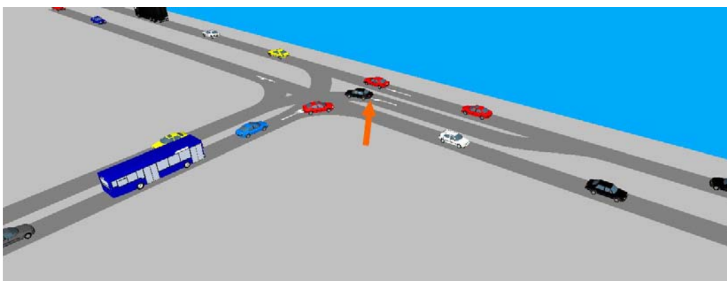
Obr. 4 - Simulace provozu na křižovatce Opavská – Studentská v Ostravě-Porubě po vložení levého odbočovacího pruhu na hlavní komunikaci
