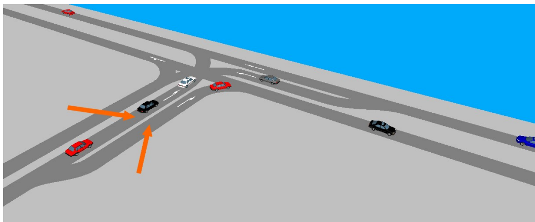
Obr. 5 - Simulace provozu na křižovatce Opavská – Studentská v Ostravě-Porubě po vložení odbočovacích pruhů na vedlejší komunikaci
