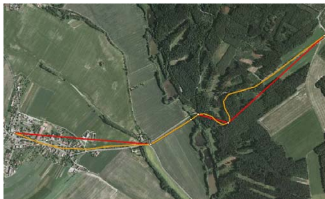
Obr. 3 – Výpočet zakřivení komunikací (žlutá: komunikace, červená: přímá vzdálenost)
