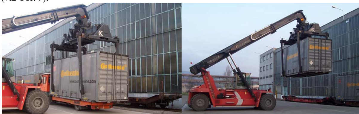
Obr. 9 - Překládka megaboxu pomocí čelního výsuvného překladače
