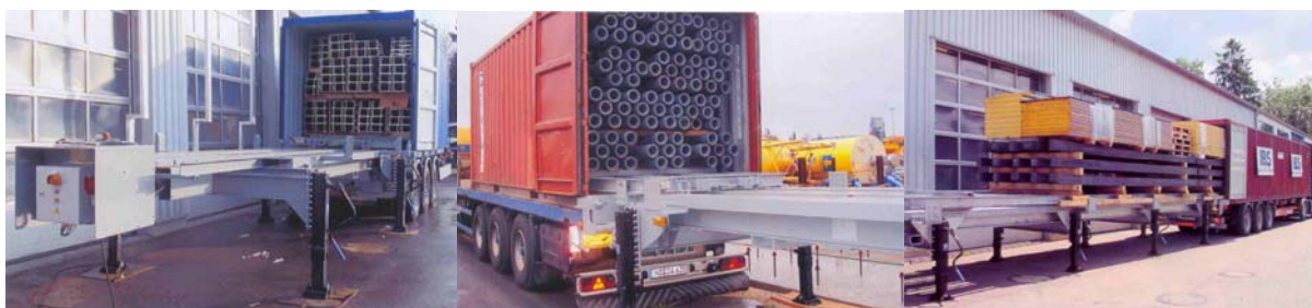
Obr. 5 - Nakládání dlouhých předmětů pomocí speciálního nakladače
