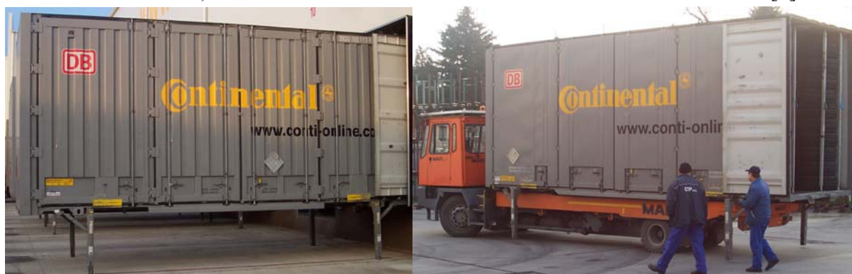
Obr. 8 - Megabox na odstavných nohách a na zvedací plošině silničního vozidla MAFI
