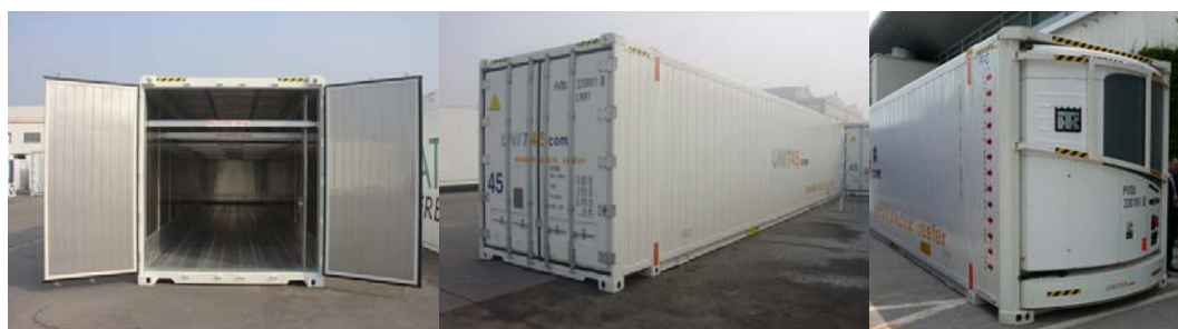
Obr. 2 - Kontejner UNIT45 Reefer - chladírenský kontejner
