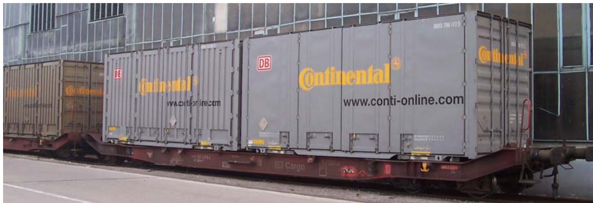
Obr. 10 - Megaboxy uložené na železničním voze řady Sgkkms 698
