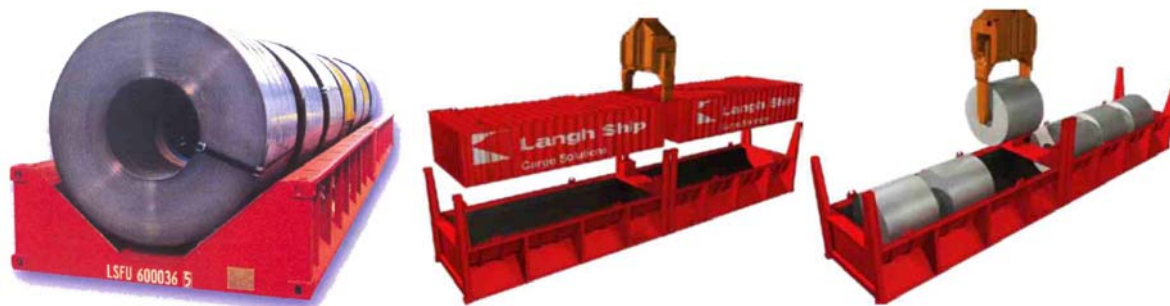
Obr. 6 - Kolébkový kontejner pro přepravu svitků
