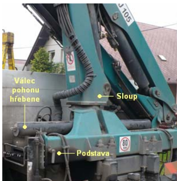
Obr. 1 - Realizace rotačního pohybu jeřábu prostřednictvím hydraulických válců a hřebenového převodu na nakládacím jeřábu OSTROJ NJ 105
