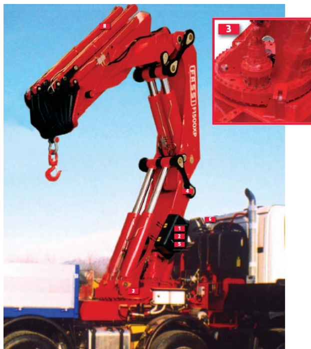
Obr. 2 - Realizace rotačního pohybu jeřábu prostřednictvím rotačního hydromotoru na nakládacím jeřábu FASSI F1500XP
