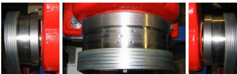
Obr. 6 - Znečištění třecího kotouče hydraulickým olejem
