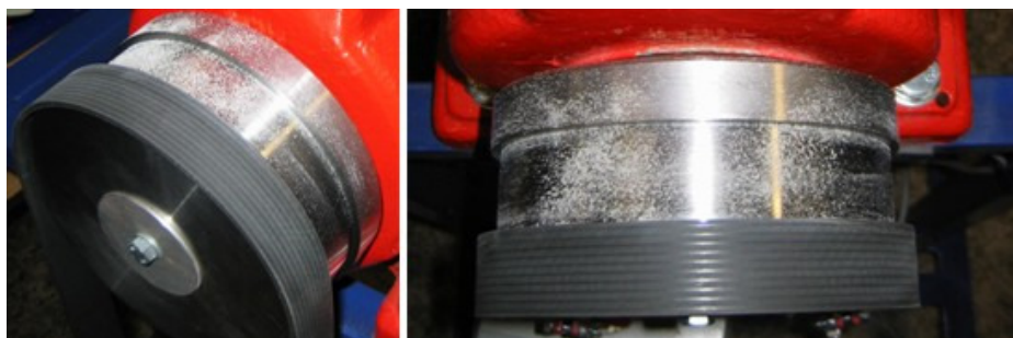
Obr. 7 - Znečištění třecího kotouče prachem
