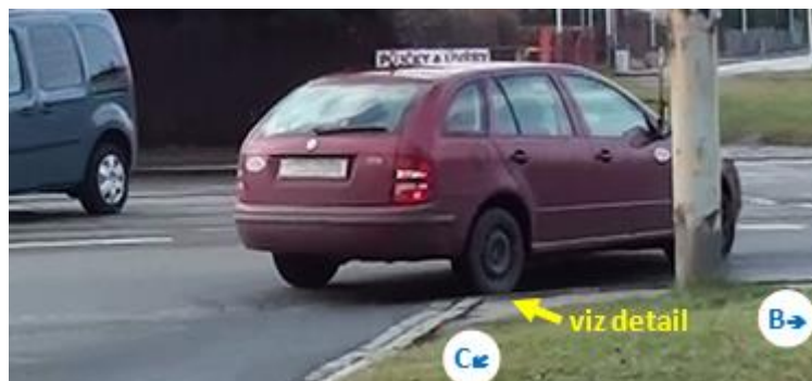
Obr. 14 – Najetí na obrubník při odbočení vpravo z ramene C do B (detail viz obr. 15) [video viz (4)]
