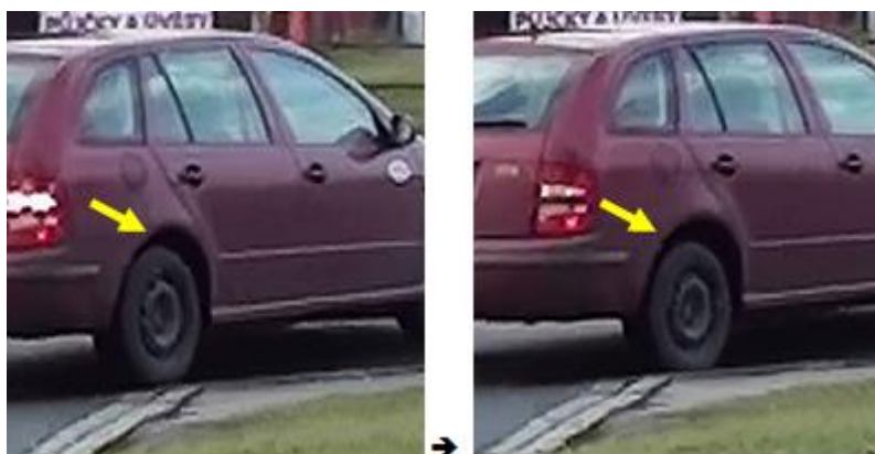
Obr. 15 – Detail najetí na obrubník v místě 1. lomu nároží č. 1 (z obr. 14); levá fotografie ukazuje okamžik, kdy kolo je již na obrubníku, pravá fotografie pak okamžik sjetí kola zpět na vozovku – je zde patrná změna velikosti mezery mezi pneumatikou a podběhem (viz šipky); mezi oběma fotografiemi uplynuly \frac{3}{25} sekundy
