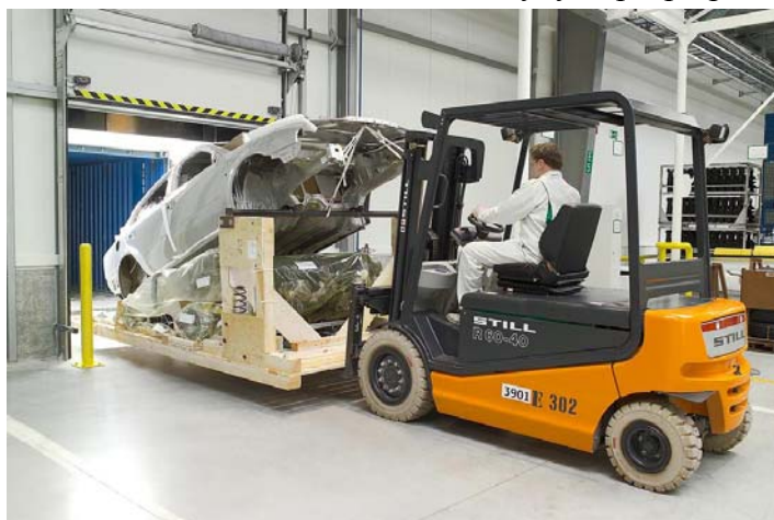
Obr. 10- Nakládání vozu v racku do přistaveného kontejneru
