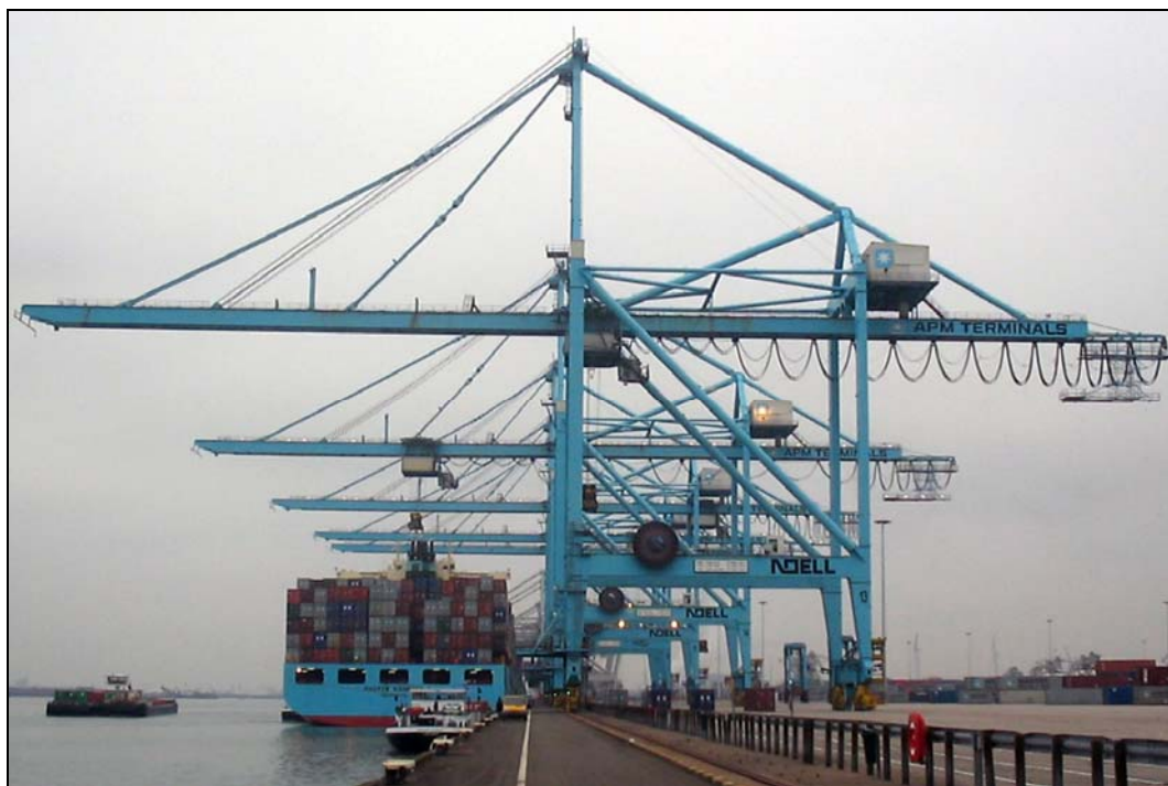
Obr. 4 - Kontajnerová loď a kontajnerový prekladač typu post Panamax
