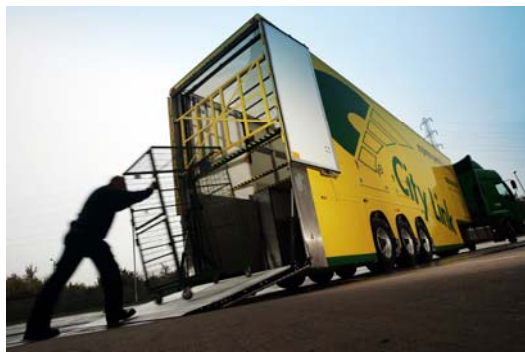
Obr. 15 - Zadní část návěsu 2WIN se sklopnou rampou a výtahem
