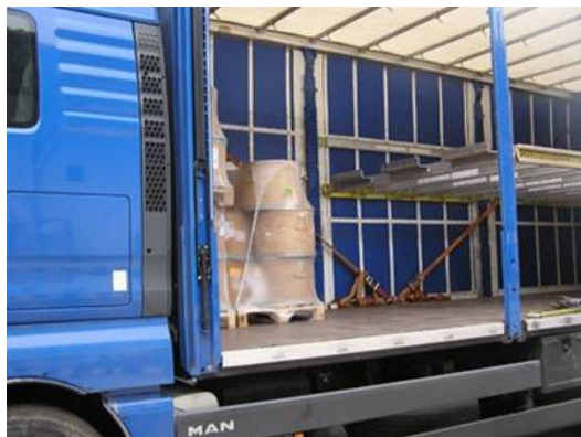
Obr. 7 - Druhá podlaha jen v zadní části nástavby valníkového vozidla
