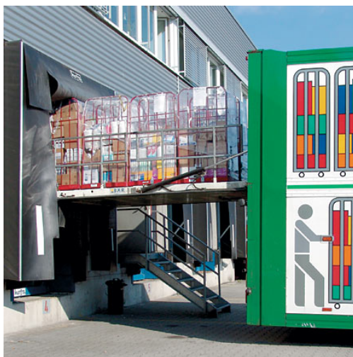
Obr. 11 - Zadní stranu návěsu může tvořit hydraulické nakládací čelo
