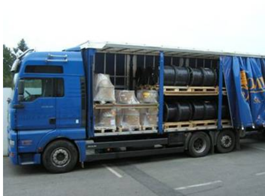
Obr. 8 - Nižší poloha druhé podlahy v první sekci ložného prostoru
