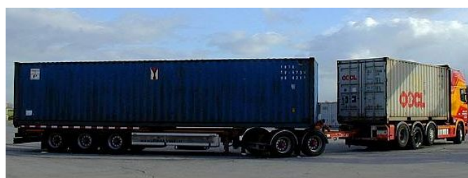
Obr. 23 - kontejner ISO 1C a ISO 1A na soupravě EMS
