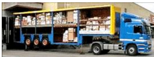
Obr. 14 - Nakládka návěsu 2WIN s teleskopickými nohami
