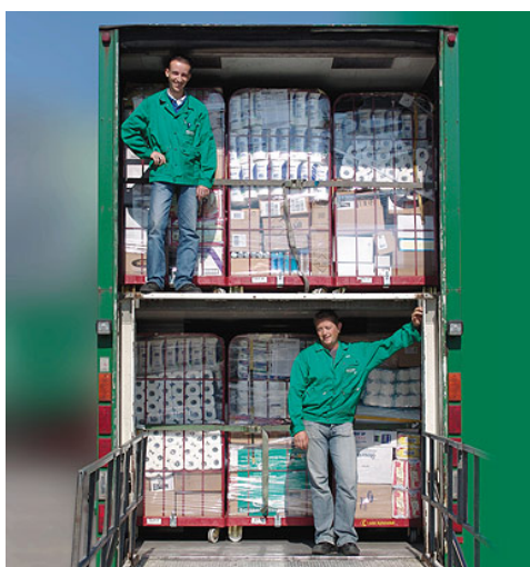
Obr. 12 - Ložná výška pater může být až 2 metry
