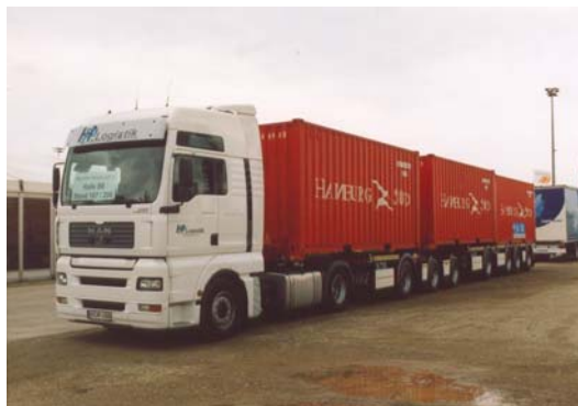
Obr. 22 - Tři kontejnery ISO 1C na soupravě EMS
