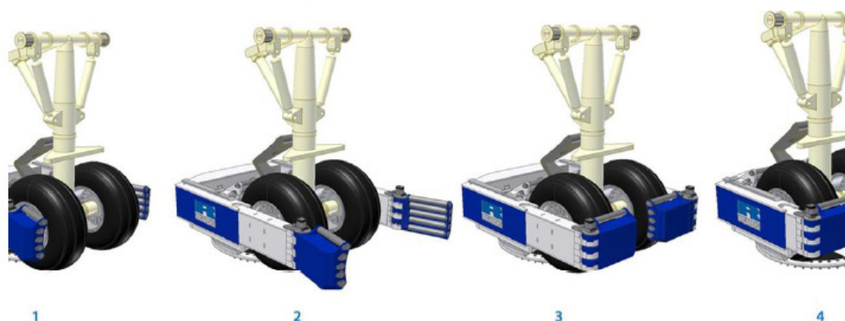
Obr. 3 – Schéma připojení části zařízení Taxibot na podvozkové kolo letadla
