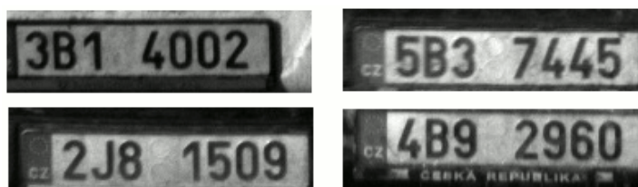
Obr. 3 - Ukázka vertikálně i horizontálně variabilního umístění detekované RZ vůči kandidátnímu výřezu
