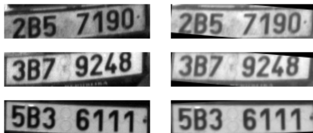
Obr. 8 - Příklady korekce natočení RZ vozidel
