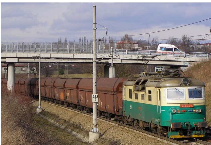
Obr. 3 - Ucelený vlak složený z vozů řady Falls s výsypnými klapkami
