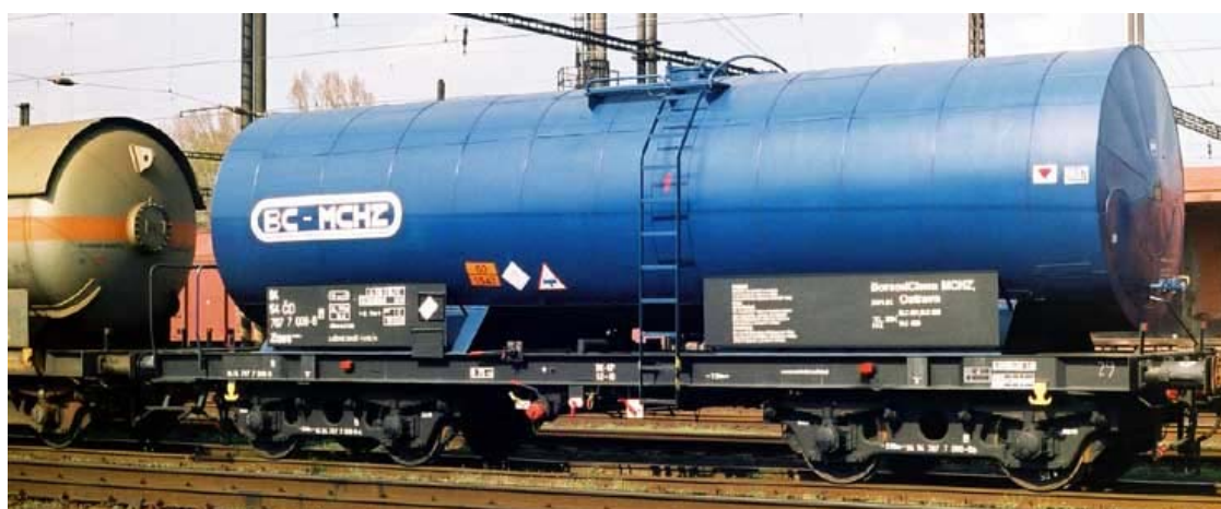
Zdroj: http://www.parostroj.net/katalog/nv/formular.php3?ind=169 Obr. 5 - Kotlový vůz řady Zaes na přepravu kapalin a plynů
