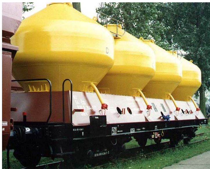
Zdroj: http://www.parostroj.net/katalog/nv/clanky/preprava_cementu/preprava_cementu_Raj.php3 Obr. 4 - Vůz řady Uacs (dříve Raj) na přepravu cementu
