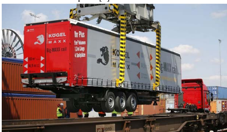
Obr. 1 - Prodloužený návěs Big-MAXX Rail při překládce na železniční vůz
