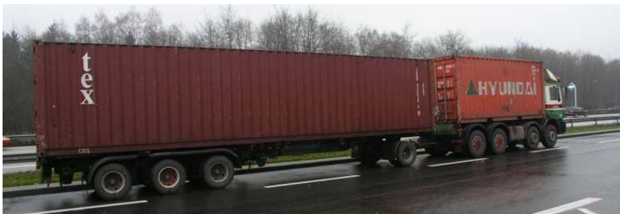
Obr. 8 - Kontejnery řady ISO 1C a ISO 1A na soupravě EMS
