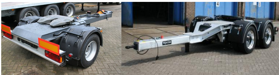
Obr. 4 - Klasický a tandemový podvozek „dolly“
