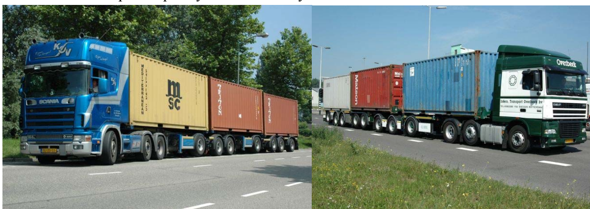
Obr. 7 - Tři kontejnery řady ISO 1C na soupravě EMS
