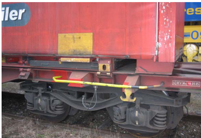
Obr. 1 – Detail příčného tunelu výměnné nástavby
