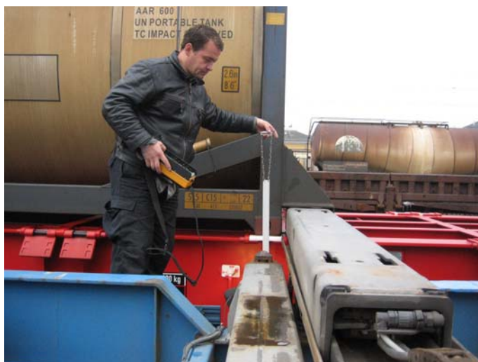
Obr. 3 – Reflexní lišta pro přesné nastavení překládacího zařízení u železničního vozu
