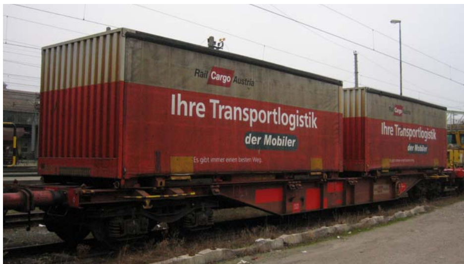
Obr. 5 – Výměnné nástavby s pevnými čely a plachtovými bočnicemi
