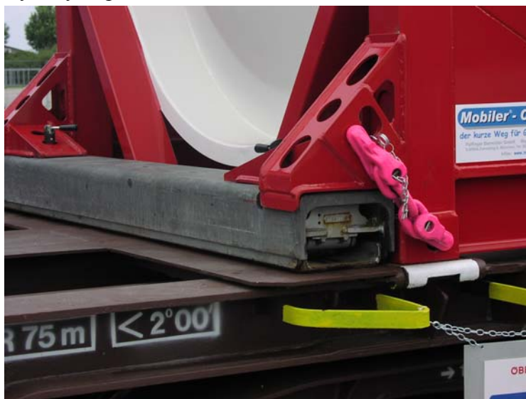
Obr. 2 - Překládací lyžina na příčném pásu železničního vozu
