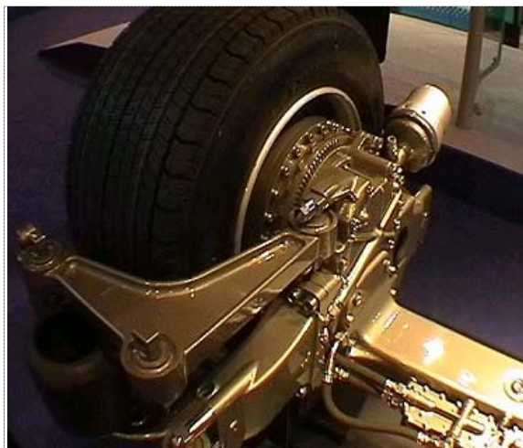
Obr. 5 Pohonná jednotka trolejbusu umístěná v pojezdovém kole [27]
