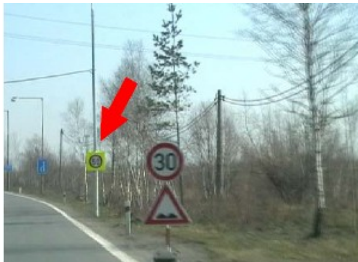
Obr. 1: Příklad matoucího svislého dopravního značení, které může vyvolat konfliktní situaci S_s (viz dříve) [5]; (pozn. v pozadí je šipkou označená svislá dopravní značka max. povolené rychlosti 50 km/h)
