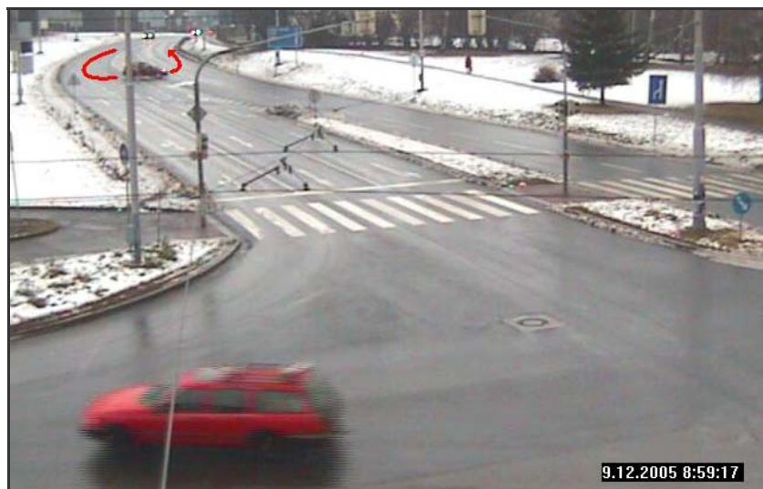
Obrázek 5: Záznam konfliktní situace [4] vozidla s vyznačením průběhu jízdy – označení 2O1.
