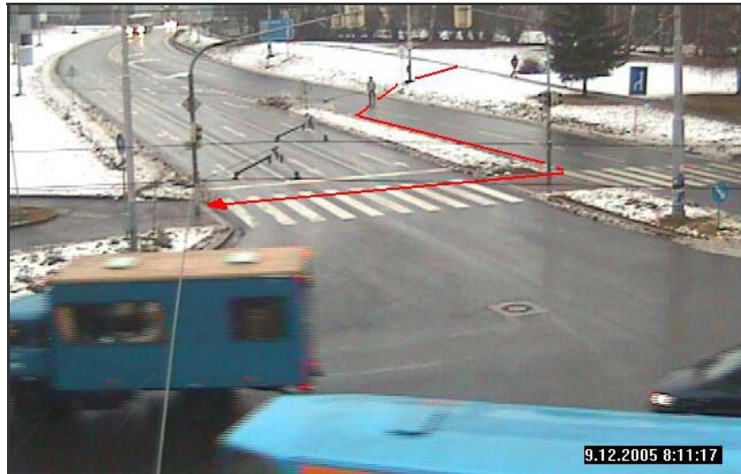
Obrázek 4: Záznam konfliktní situace [4] chodce s vyznačením průběhu chůze – označení 1ch1.
