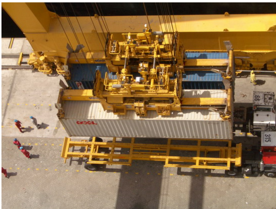
Obrázek 1: Dvojité spreadry přeloží dva 40' kontejnery
