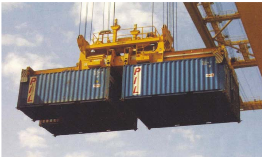
Obrázek 2: Moderní spreadry přeloží až čtyři 20' kontejnery
