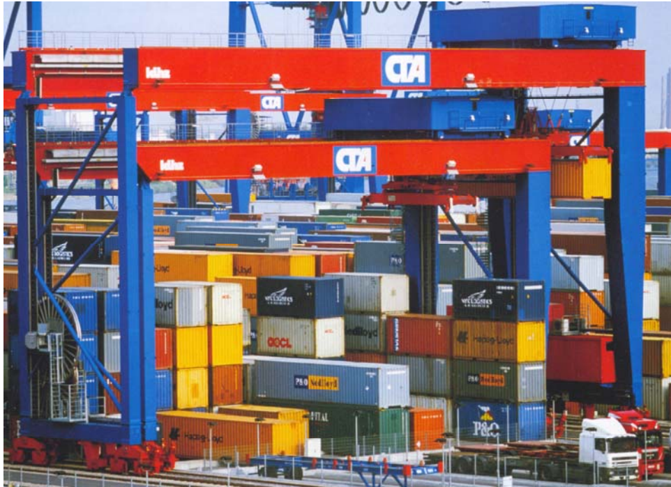
Obrázek 3: Automatické portálové jeřáby (ASC) v terminálu CTA
