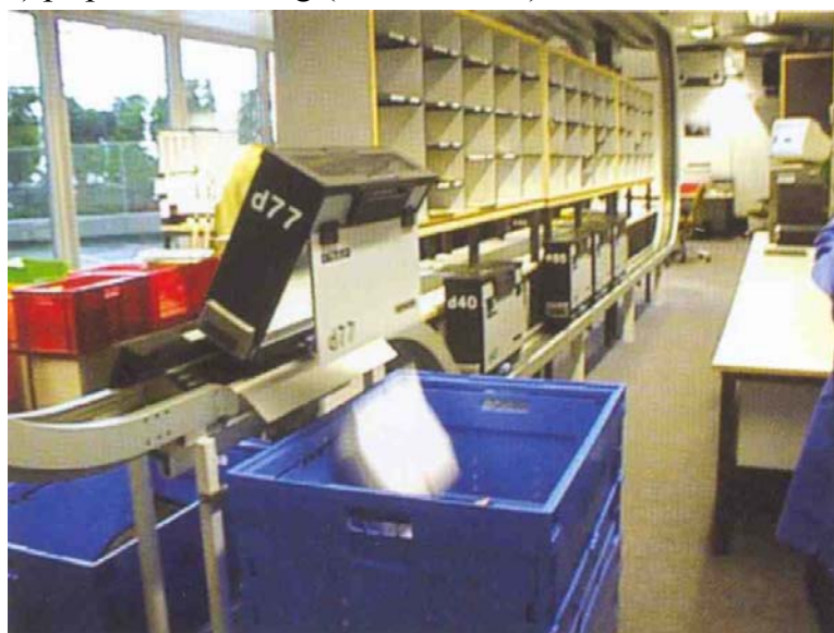
Obr. 5: Unicar v knihovnách – samovolné vyložení nákladu
