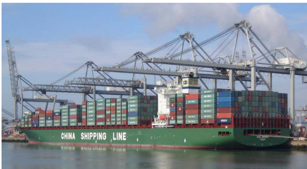
Obr. 4: kontejnerová loď CSCL AMERICA s kapacitou 8 498 TEU a ponorem 14,5 m
