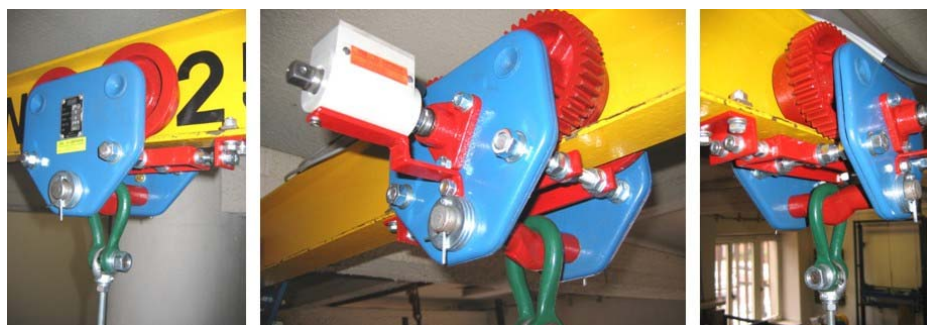
Obr. 8 - Realizace zařízení k určení součinitele adheze při rozjezdu podvěsného jeřábového vozíku
