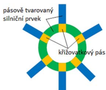
Obr. 8 - Příklad pásu kruhového objezdu
