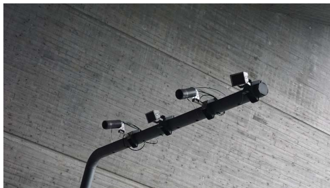
Obr. 1 – Systém ANPR pre výber mestského elektronického mýta
