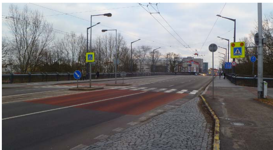
Obr. 1 – Zvýraznění svislé dopravní značky a použití optickoakustické brzdy před přechodem pro chodce (Pardubice, Hradecká ulice)
