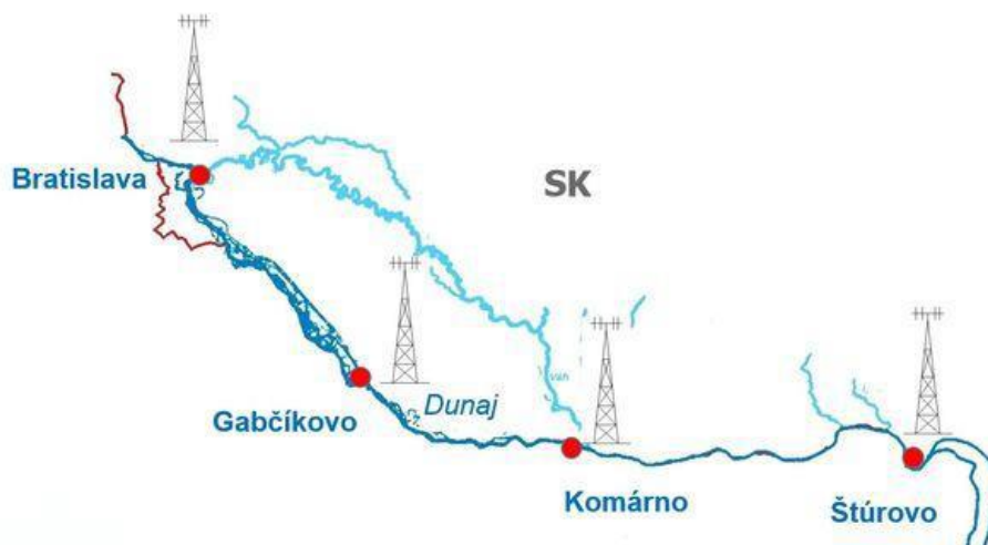
Obr. 3 - Rozmiestnenie základňových staníc a pokrytie signálom AIS (2)
