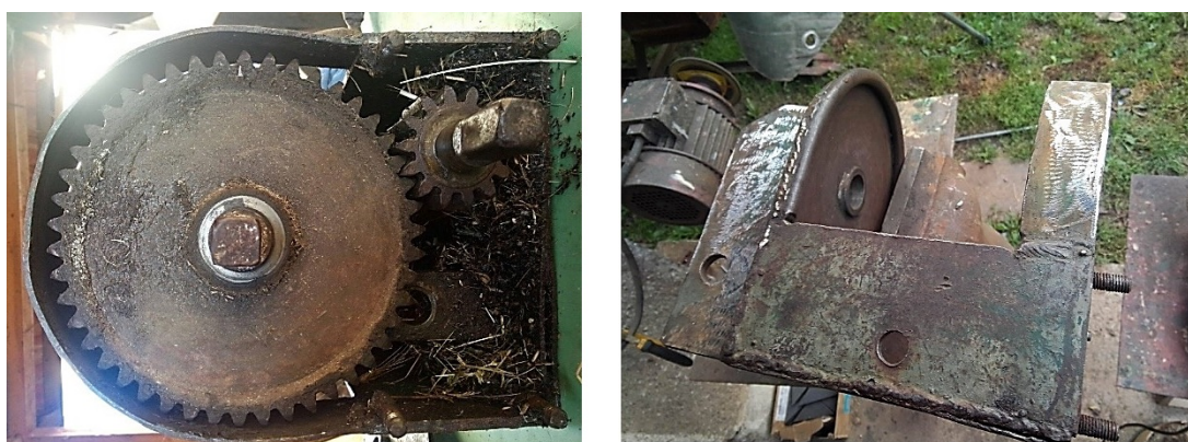
Obr. 2 – Pohľad na demontáž (vľavo) a odstraňovanie poškodeného náteru zo skrine navijaka (vpravo)
