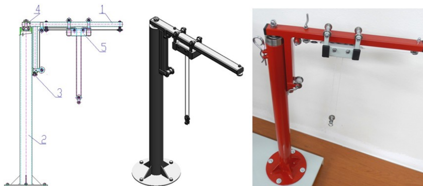
Obr. 10 - Model sloupového jeřábu. 2D konstrukční návrh v prostředí v AutoCad, 3D konstrukční návrh v prostředí v SolidWorks, fyzická realizace
