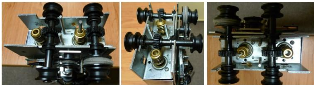
Obr. 4 - Realizace pojezdového mechanismu jeřábového vozíku
