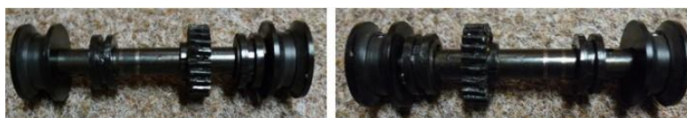
Obr. 2 - Hnací hřídel pojezdových kol jeřábového vozíku
