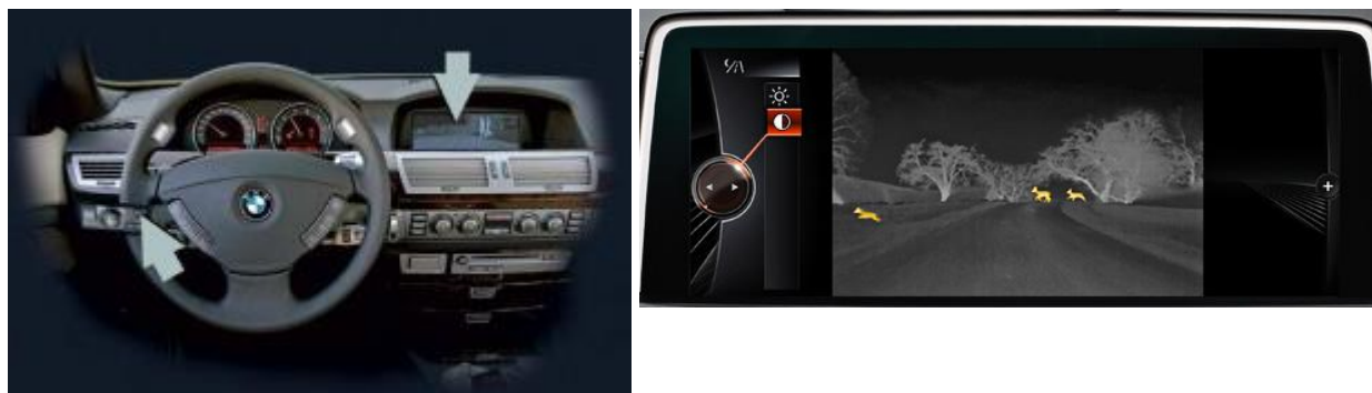
Obr. 5 - Senzor zvěře ve vozidle BMW v systému Night Vision
