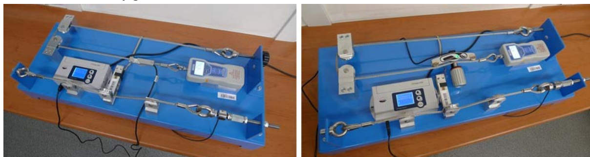
Obr. 6 Zařízení ke snímání osových sil v lanech zdvihacích zařízení - fyzická realizace
