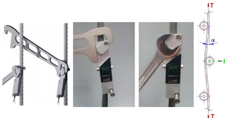
Obr. 3 Vedení lana přes opěrné body tělesa snímače napětí lan
