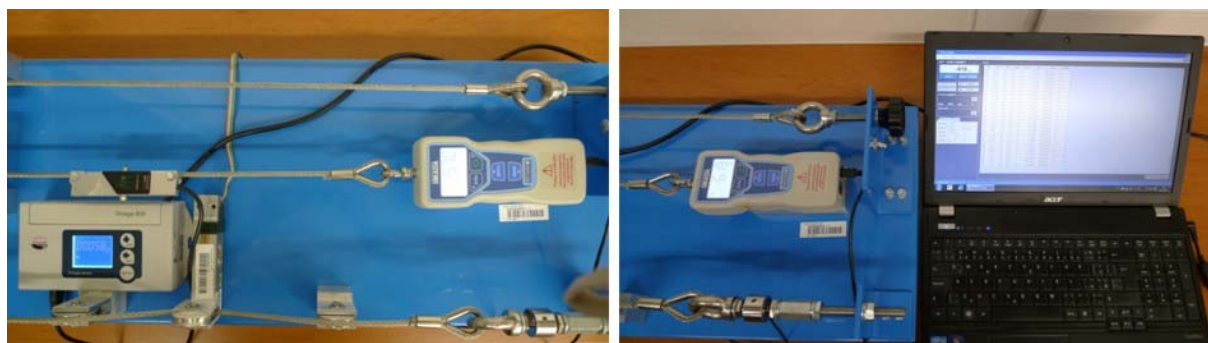
Obr. 7 Tahová síla v laně snímána digitálním siloměrem a její zobrazení na PC v prostředí programu Force Logger verze 1.01
