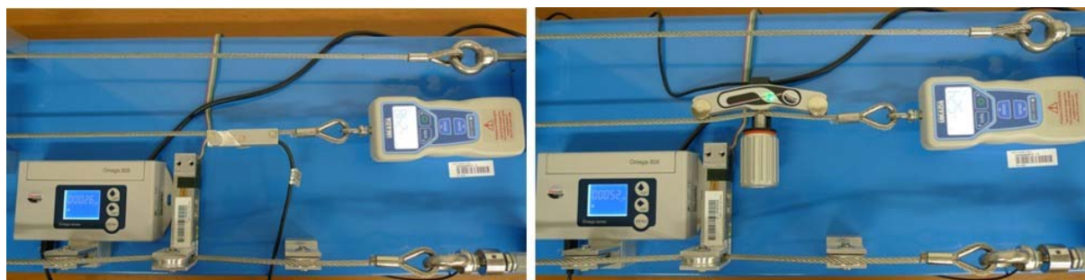
Obr. 8 Odečítání hodnot tahové síly T [N] z digitálního siloměru a hodnot osového zatížení T_G [kg] z řídicí jednotky OMEGA 806
