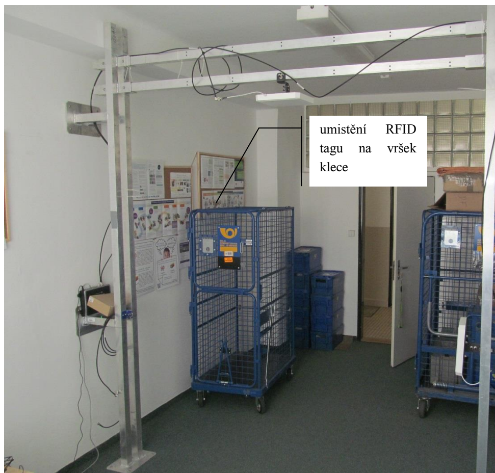
Obr. 6 – umístění RFID tagu na vrch klece
