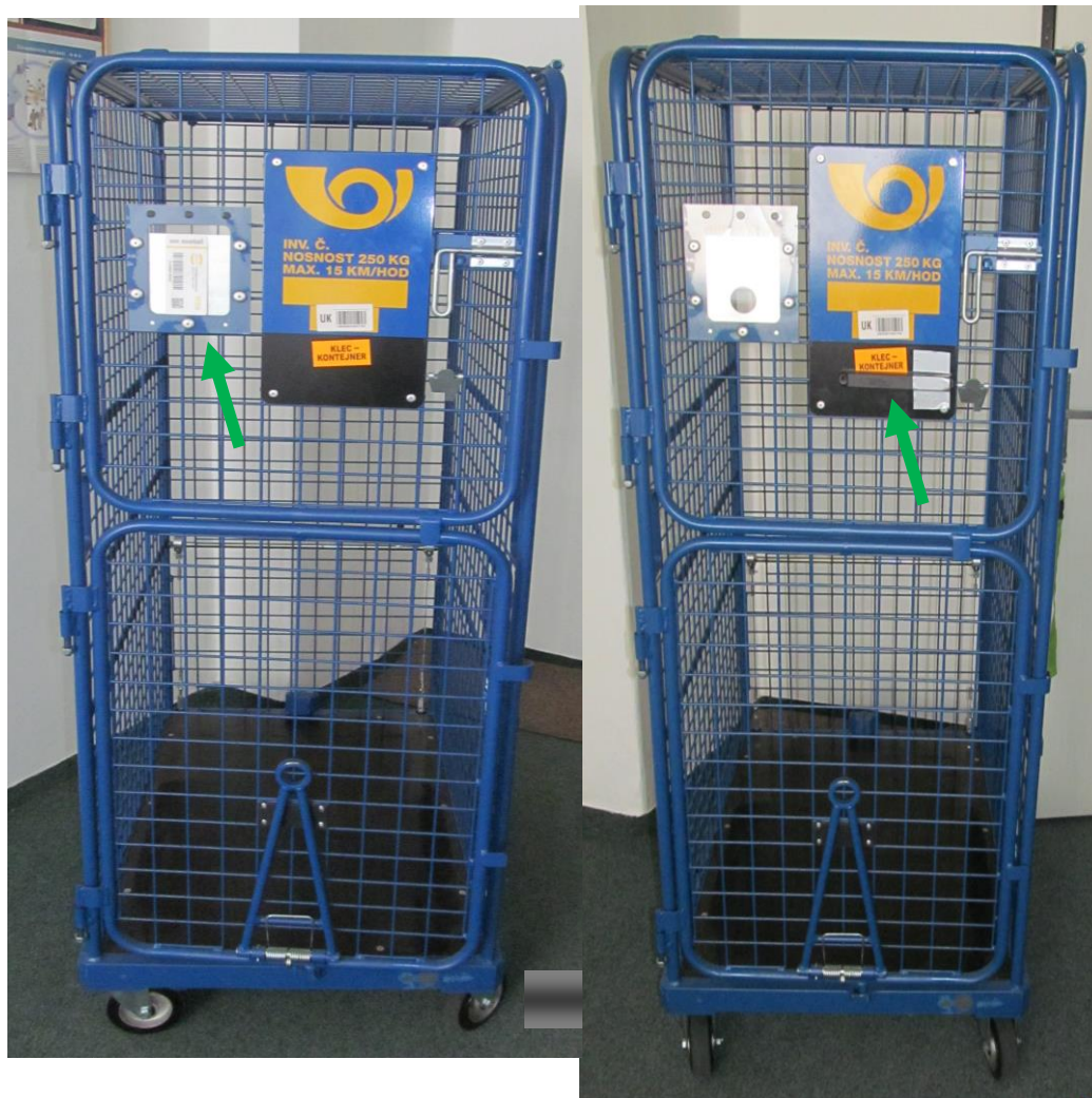
Obr. 5 – umístění RFID tagu na dveřích klece
