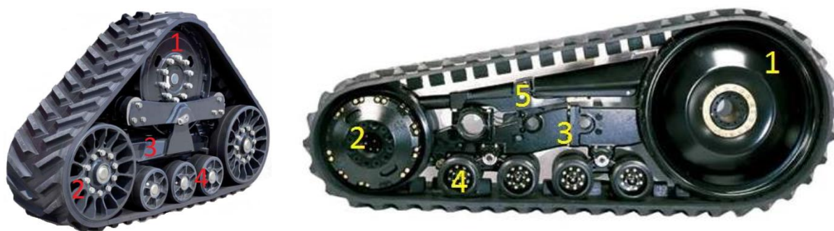
1 - hnací kolo, 2 - napínací kolo, 3 - centrální kolo, 4 - středové vodící kladky, 5 - napínací mechanismus
