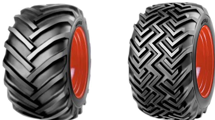
Obr. 5 – Nízko profilový dezén vhodný pro provoz na travnatých plochách
