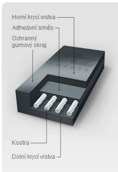
Obr. 5 – Skladba ocelokordového dopravního pásu
