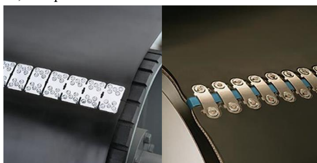
Obr. 7 – Spoj s pevnými spojkami (šroubované a nýtované)
