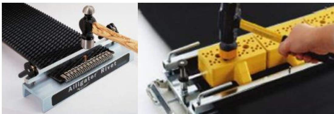
Obr. 11 – Způsoby montáže nýtovaných spojek
