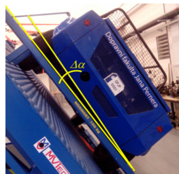
Obr. 10 - Závislost náklonu karoserie na slonu plošiny
