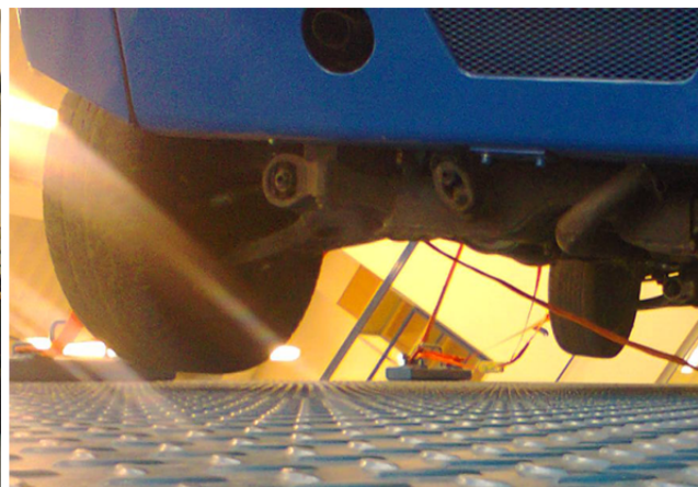
Obr. 8 - Ztráta kontaktu kola s podložkou
