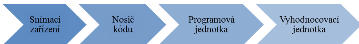
Obr. 1 – Obecné schéma prvků technologie AIDC
