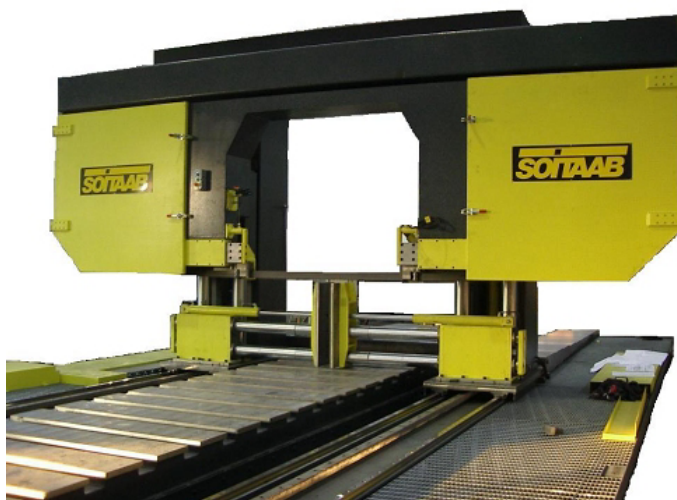
Obr. 1 - Zvárací a rezací portál SOITAAB s kapacitou 2000 x 2000 x 5000 (mm) Zdroj: http://www.soitaab.com/eng/mainindex_eng.html
