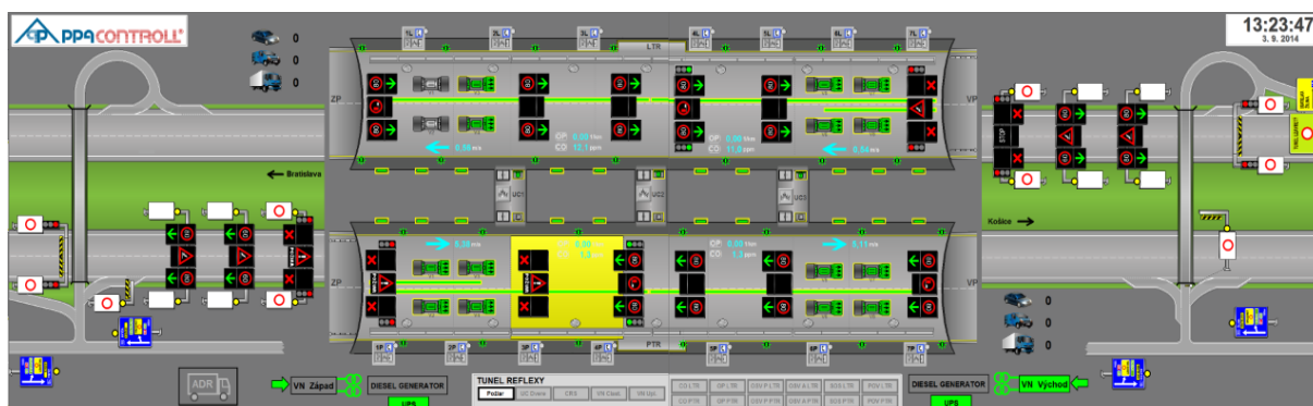
Obr. 4 – Požiar v tuneli, stav technológie a riadenia dopravy
