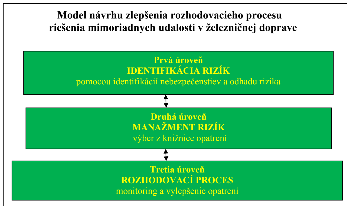
Obr. 1 - Trojstupňový model návrhu na zlepšovanie rozhodovacieho procesu v preprave nebezpečného tovaru po železnici
