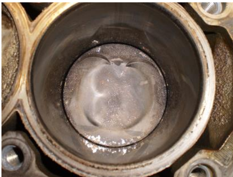
Obr. 2 - Následky klepání při kompresi 12,5:1
