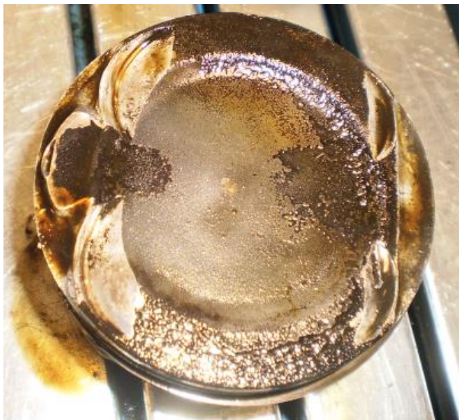
Obr. 3 - Opálená koruna pístu při kompresním poměru 12,5:1
