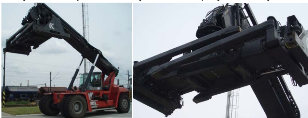
Obr. 3: MP s detailním pohledem na spreader se sklopenými kleštinami
