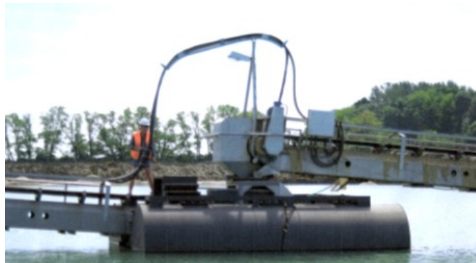
Obr. 1 - Plovákové těleso válcového tvaru plovoucí pásové dopravní trasy
