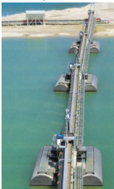
Obr. 2 - Plovákové těleso válcového tvaru plovoucí pásové dopravní trasy
